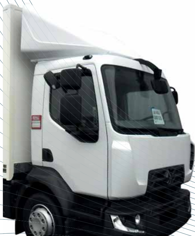
Défecteur positionnable cabine courte
